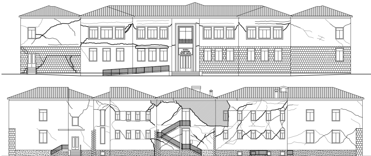
Figura 2 – Restituzione del quadro di danno della Scuola P.Capuzi di Visso (secondo i dati raccolti da S.Cattari e D.Sivori a seguito di un sopralluogo effettuato in data 8 Dicembre 2016): le linee nere più spesse sono associate a lesioni molto gravi. La porzione evidenziata in grigio è quella in cui si è attivato un meccanismo di ribaltamento fuori piano dopo la scossa del 26 Ottobre 2016
