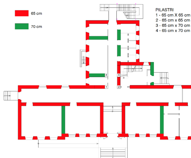
Figura 1 – Identificazione dello spessore delle pareti del Piano Terra.
