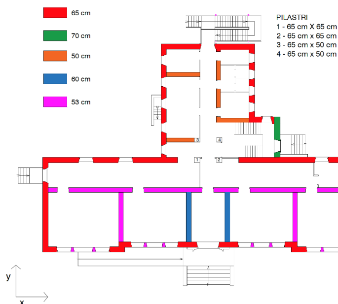
Figura 2 – Identificazione dello spessore delle pareti del Piano Primo.
