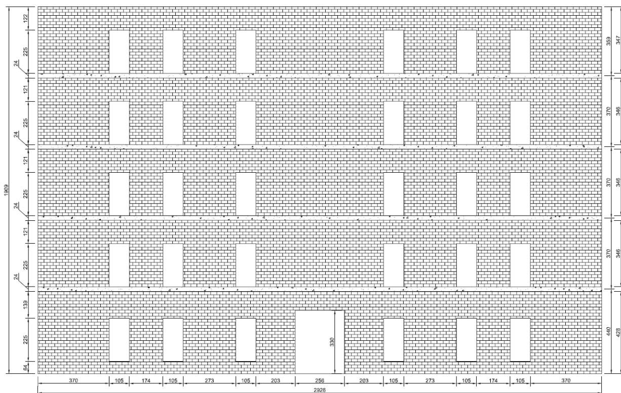
Figura 2– Geometria della struttura benchmark n°3 (la figura a titolo di esempio si riferisce alla variante di tipo C proposta, ossia con cordoli di piano)
